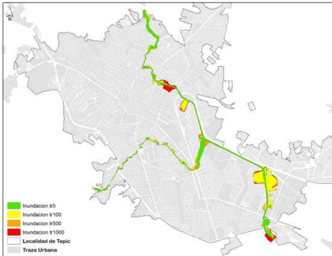
Ilustración 1 Incremento de zonas potencialmente inundables.
